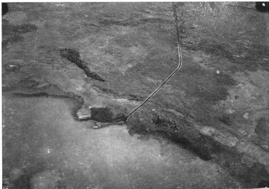
Fig. 138 — Canalização do rio da Prata nos pantanais de Guriri pelo D.N.O.S. Em baixo, a lagoa Feia
