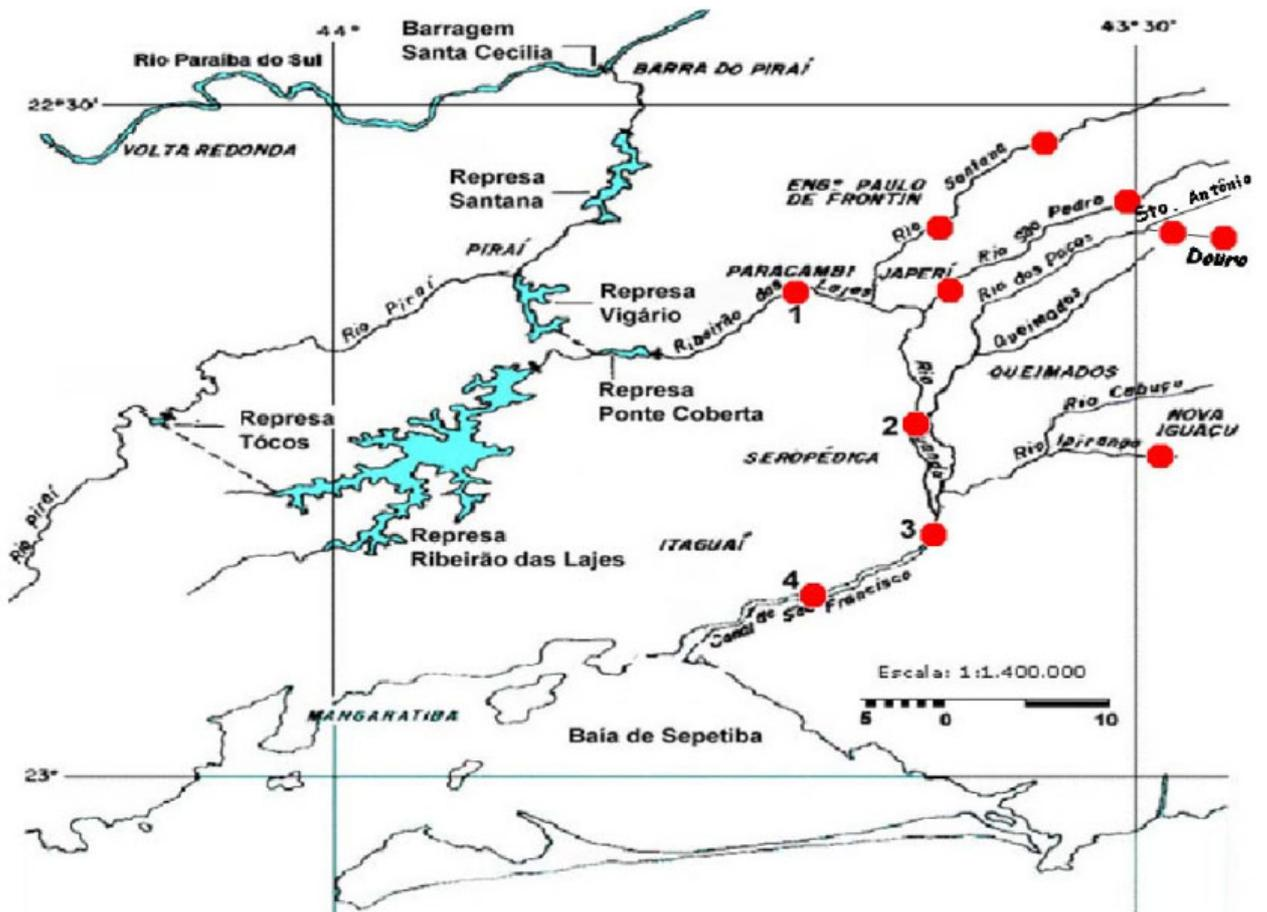
Figura 1 – Representação hidrográfica da *transposição PBS/Guandu*.
